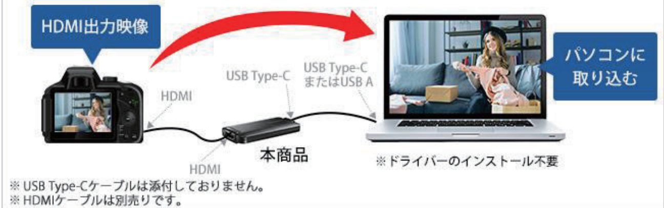
Figure 3. HDMI-USB 変換アダプタの例と接続方法 (アイ・オー・データ社 Web サイトより引用)
